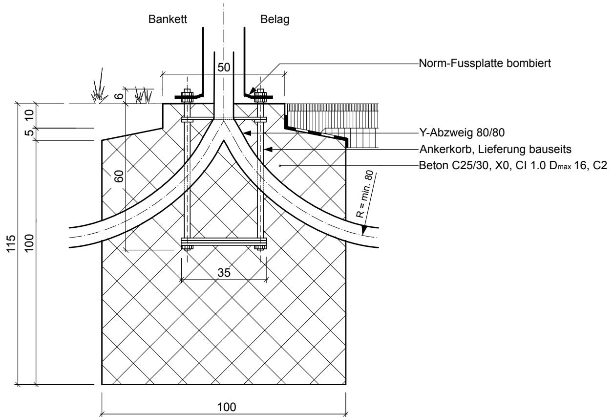
— Beton reinigen und auftragen eines Voranstriches (Haftklebers) plus Heissbitumen oder geeigneter Kantenvoranstrich in 2 bis 3 mm Stärke
