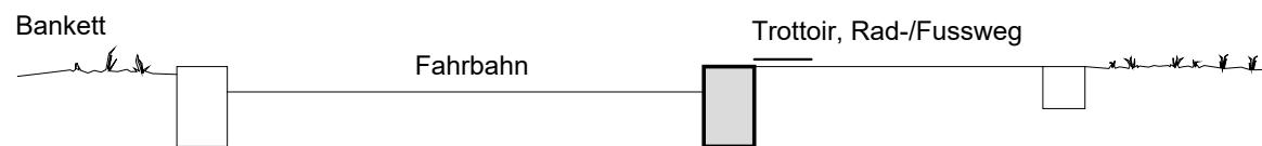
**Binderstein (Schalenstein) Typ 12 Spez. mit Wassersteinplatte, Anschlag: 6 cm,
