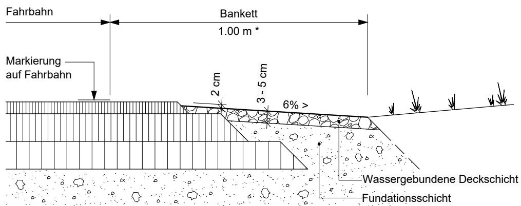
\* In Absprache mit dem Tiefbauamt kann die Bankettbreite bis auf 50 cm reduziert werden
