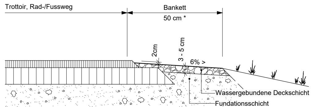
\* In Absprache mit dem Tiefbauamt kann die Bankettbreite bis auf 30 cm reduziert werden
